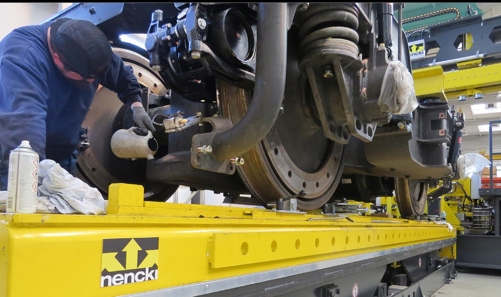
Der neue Nencki Drehgestell Montagestand NBA zur ergonomischen Montage und Demontage von Drehgestellen.
